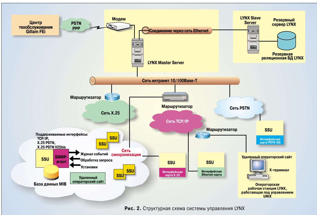
Рис. 2. Структурная схема системы управления LYNX
